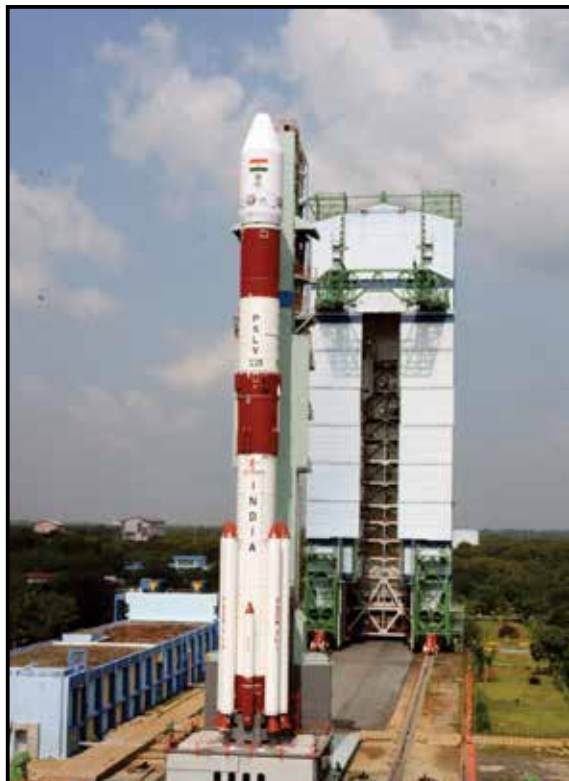
पी.एस.एल.वी.-सी 25 का फोटोग्राफ, यह वह राकेट है जो मंगल परिक्रमा अभियान को ले गया था। इस राकेट की ऊँचाई 45 मीटर है, व्यास 3 मीटर है और वजन लगभग 300 टन है। यह राकेट 1500 किलोग्राम भार तक के पेलोड को जियोसिंक्रोनस ऑर्बिट (पृथ्वी के समान गति से घूमने वाली कक्षा, जो पृथ्वी के सापेक्ष स्थिर रहती है) में स्थापित कर सकता है। © : इसरो
